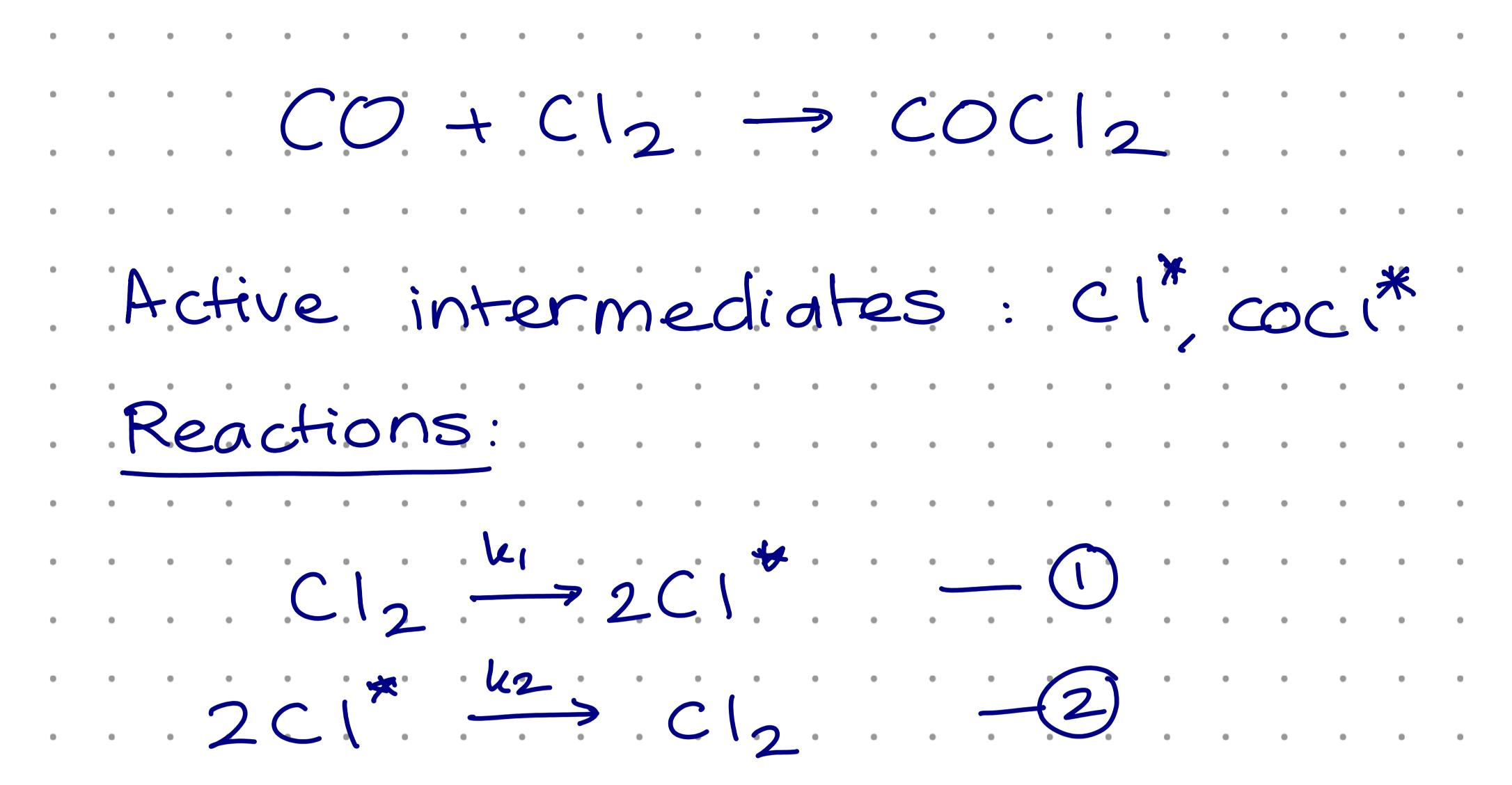
$CO + Cl^{*} \xrightarrow{k_3} COCl^{*} - 3$  $COCL * \frac{k_4}{2} CO + Cl^* - 4$  $COCl^* + Cl_2 \xrightarrow{k_5} COCl_2 + Cl^* - (5)$ • • • • • • • • Rates: • • • • •  $v_1 = k_1 [C_1 z]$  $r_2 = k_2 \left[ C(*) \right]^2$ • • • • • • •  $r_3 = k_3 [Co][cl*]$
